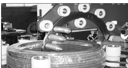
Abb. 10 Einwickelstation für Stretchband
