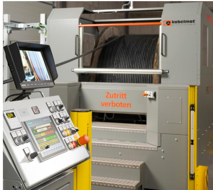
Per Touchpanel kann der Bediener die erforderliche Zugkraft und die Geschwindigkeit zwischen Ab- und Aufwickler ideal einstellen.
