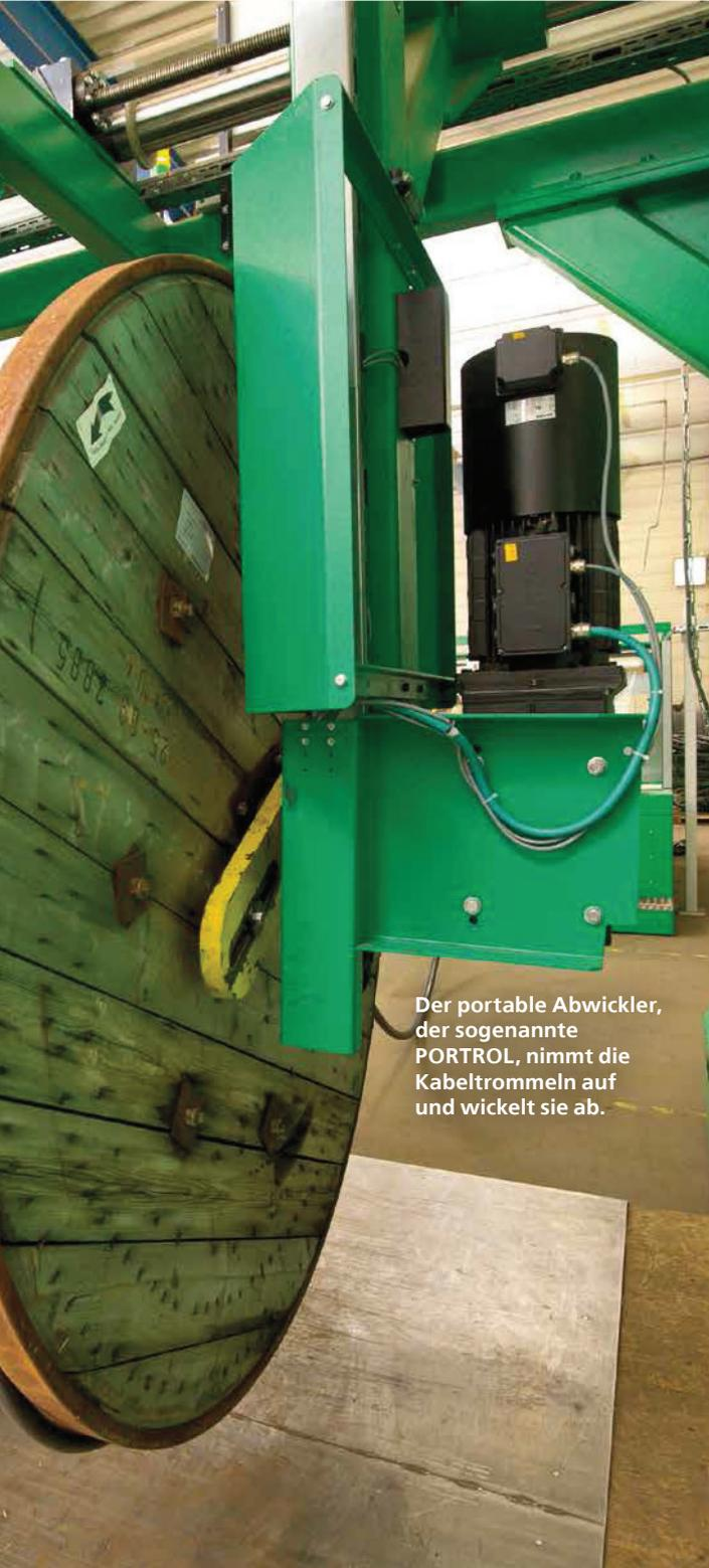
Der portable Abwickler, der sogenannte PORTROL, nimmt die Kabeltrommeln auf und wickelt sie ab.
