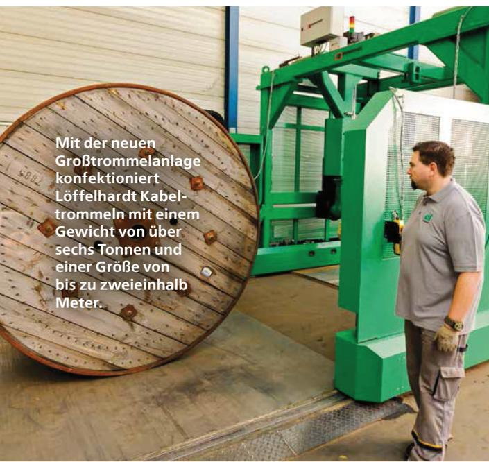
Mit der neuen Großtrommelanlage konfektioniert Löffelhardt Kabeltrommeln mit einem Gewicht von über sechs Tonnen und einer Größe von bis zu zweieinhalb Meter.
