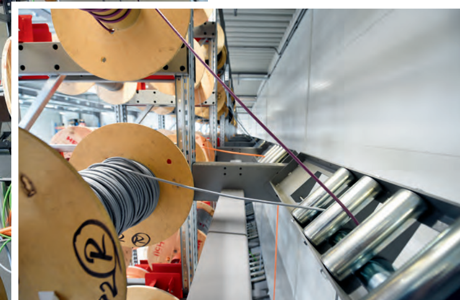
Jedes Kabel wird beim Herunterziehen über eine Umlenkrolle zum Bediener geführt – so kommen sich die Leitungen beim Ablängen nicht in die Quere.
