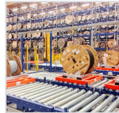
Förderstrecke zwischen Regal und Maschine
