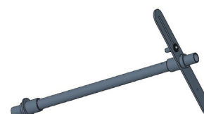
Abb. 15 Trommelachse inkl. Mitnehmer
