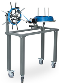
Ringwickelkopf RAPID SP in Kombination mit unserem manuellen Ring- und Spulenumwickler MESSROL 450
