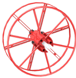
Ringwickelkopf RAPID ST Verstellung des Ringinnen-Ø in Stufen
